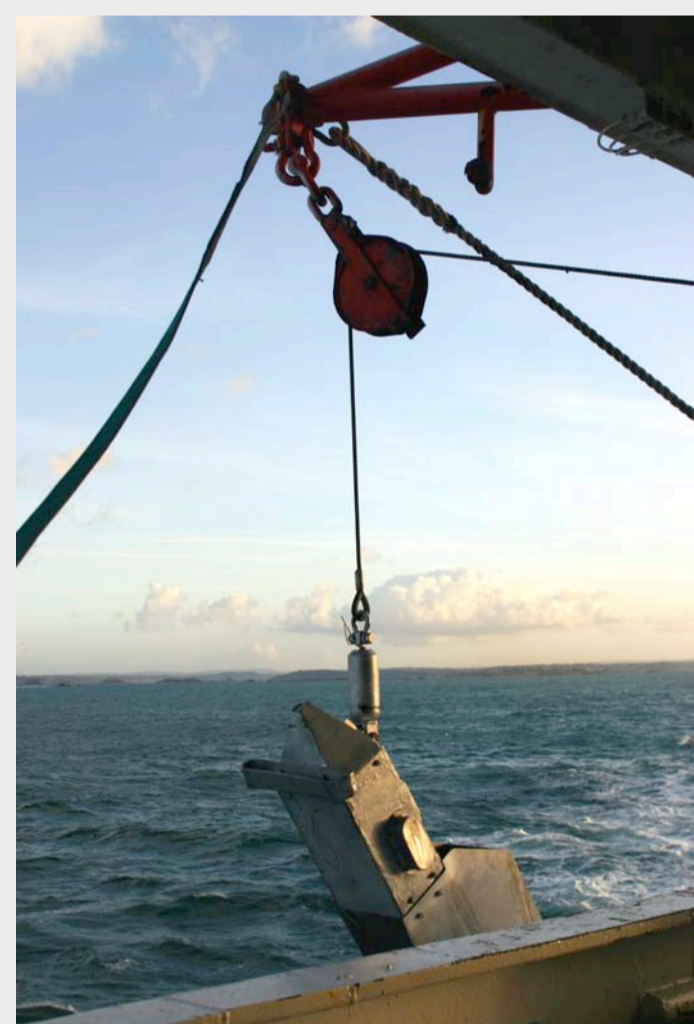
Fig. 3 : La mise à l'eau du CPR ( Continuous Plankton Recorder ), instrument permettant d'étudier la distribution géographique des différentes espèces planctoniques. SAHFOS.
